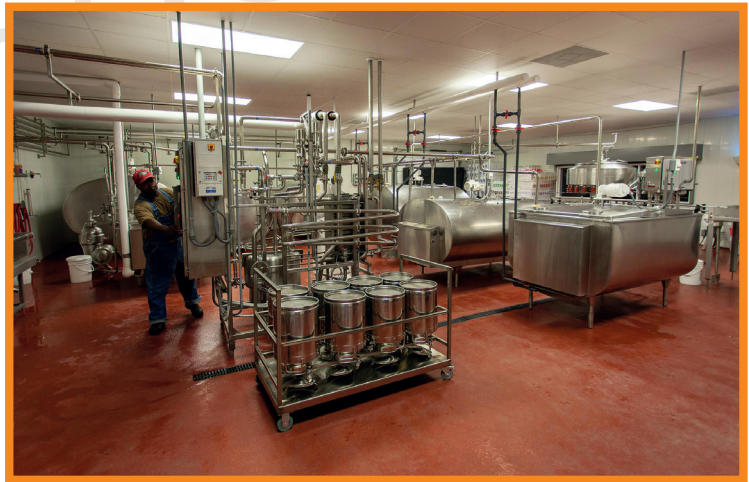
Fíor 1.8 Úsáidtear paistéaradh chun formhór na microrgánach i mbainne a mharú.
